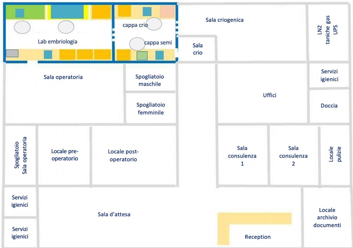
Fig. 1. Schema di un piccolo centro PMA. Superficie: circa 200 mq; capacità: da 200 a 400 cicli/anno. La disposizione consente la costruzione a partire da moduli standard. Progetto: G. Vajta
