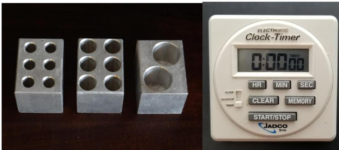
**Fig. 6:** a. Termoblock di alluminio per riscaldare le provette, b. Timer da banco Jadco
