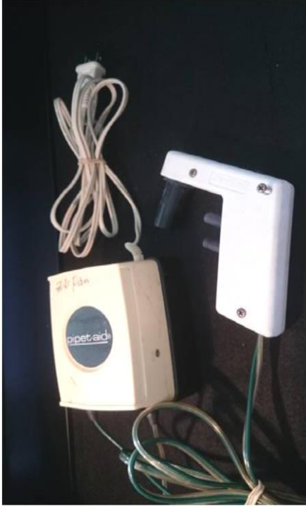
Şekil 11. Solaklar için POP'un ilk düzenlemiş görünümü. Ayrı bir pompaya bağlı eski model bir pipet ucu ve regülatörün yapısı. POP için potansiyel bir analog.
