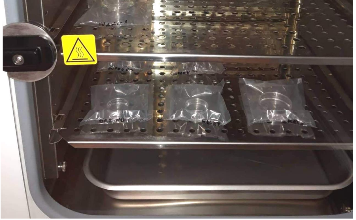
Şekil 8. Folyo torba sistemli geleneksel inkübasyonun hibrit uygulaması. Bu uyarılama, ısı stabilitesinin sağlanması ve istenen ısıya hızla dönüş dışında SIS'in tüm avantajlarına sahiptir. Bu parametreler geleneksel inkübatörlere göre daha iyidir. Lütfen not edin: Gaz ve nem ihtiyacı yoksa geleneksel dolap tipi inkübatörler sadece ısıyı sağlarlar.
