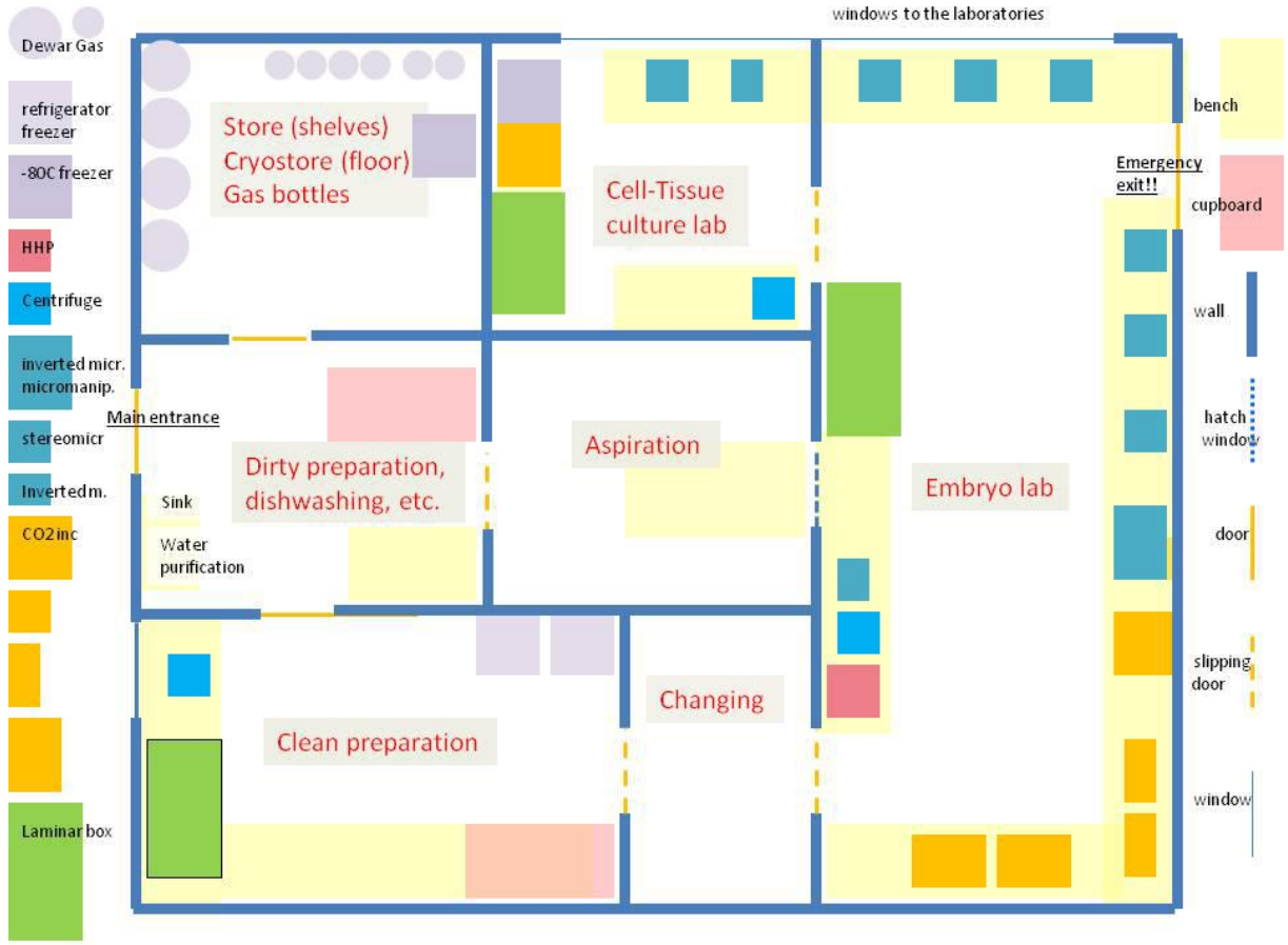
Şekil 3. Büyük hayvanlarda, mezbahadan toplanan ovaryumlardan oosit elde etmek, in vitro maturasyon, fertilizasyon, somatik hücre nükleer transferi, in vitro embriyo kültürü ve kriyoprezervasyon için tasarlanmış laboratuvar. Taban alanı yaklaşık 100 m 2 . Kapasite: 4-6 araştırmacı, 3-4 teknik personel ile yılda 100.000 in vitro matür oosit üretimi. Düzenlemeler taşınabilir konteynerlere uygun olacak şekilde yapılmış olmasına rağmen bazı ayrı servis ünitelerinin olması gereklidir.
