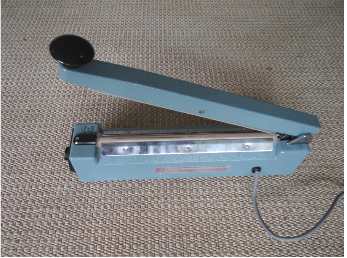
Şekil. 9: Üstten basmalı demir ısıtıcılı kapayıcı. SIS folyolarını kapatmak için uygun bir cihazdır.
